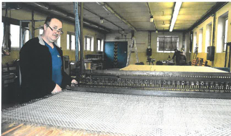
Za ručně vyráběnými sítami, která jsou v další fázi používána ve výrobě radarů, stojí Jaroslav Sitta.
